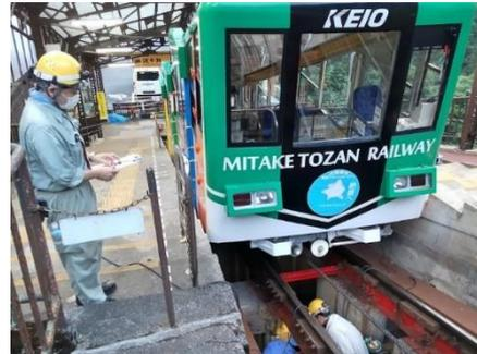
車両台車枠磁粉探傷検査
